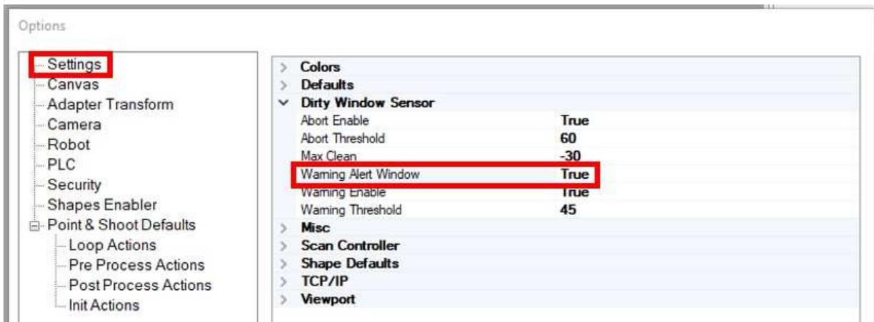
警告アラートウィンドウの有効時に警告しきい値の超過が発生すると、ポップアップが表示され、ログウィンドウにはステータスメッセージが表示されます。図 8-9 を参照してください。警告アラートウィンドウの無効時に警告しきい値の超過が発生した場合は、ログウィンドウにメッセージが表示されるだけです。
