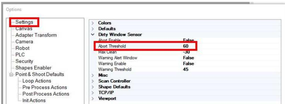
12. 必要に応じて、ダーティウィンドウセンサー中断機能および警告機能を有効にします。図 8-7 で、中断と警告の両方の機能が有効に設定されているのが確認できます。以下に、IPGScan が有効な場合に各機能に期待される動作を説明します。
